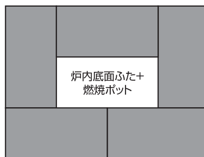
ストーブ本体(燃焼部)炉内 耐火レンガ底部配置図
